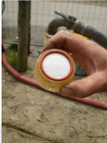
Meting slibhoudendheid met een filterspuit.
